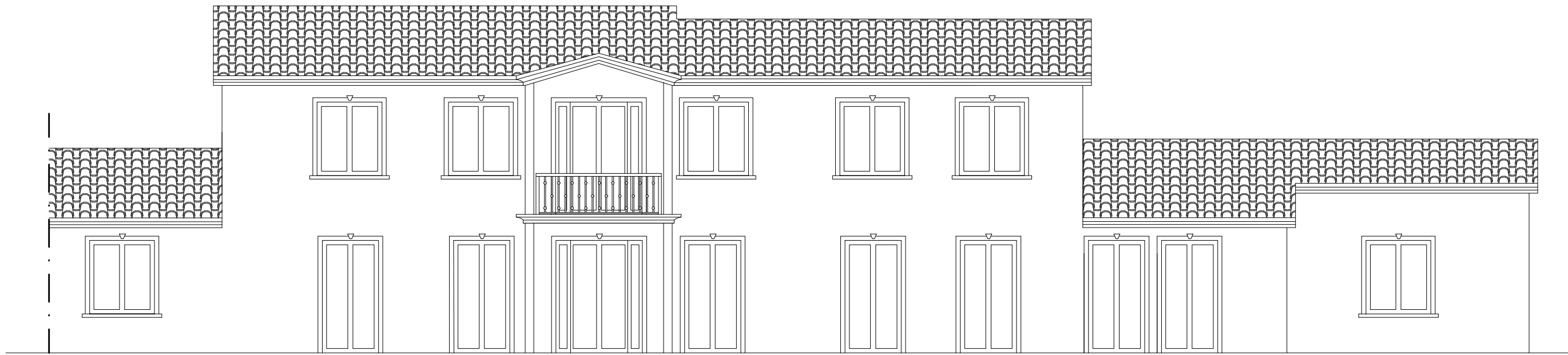
PROSPETTO LATO NORD Scala 1:100
